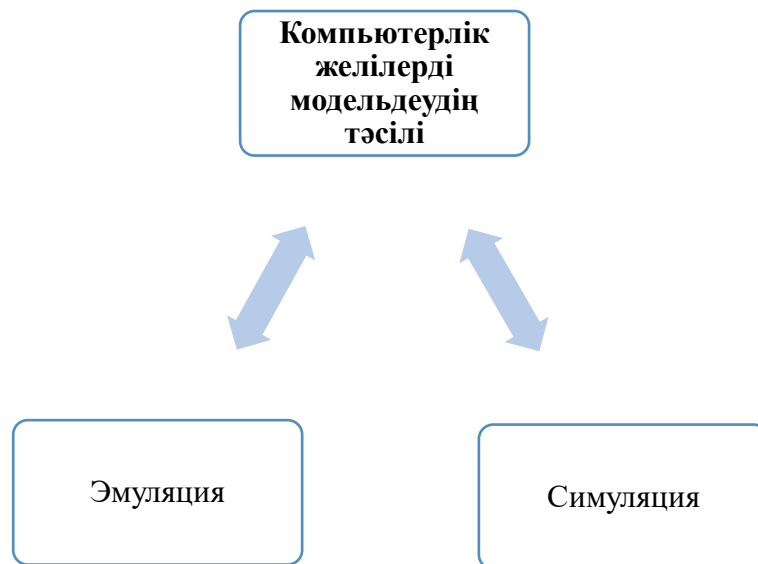
Сурет 1 – Компьютерлік желілерді модельдеудің негізгі тәсілдері
